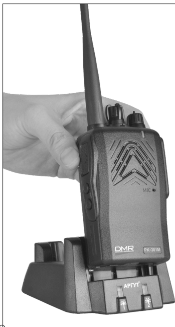
Рис. 7. Установка радиостанции с присоединённой аккумуляторной батареей в слот 1 зарядной базы.
