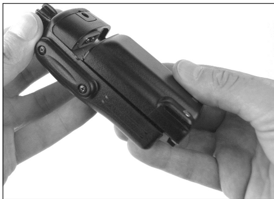
Рис. 2. Установка аккумуляторной батареи.
