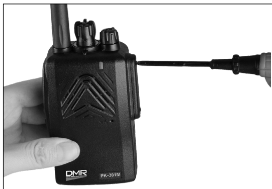
Рис. 10. Снятие заглушки аксессуарного соединителя.
