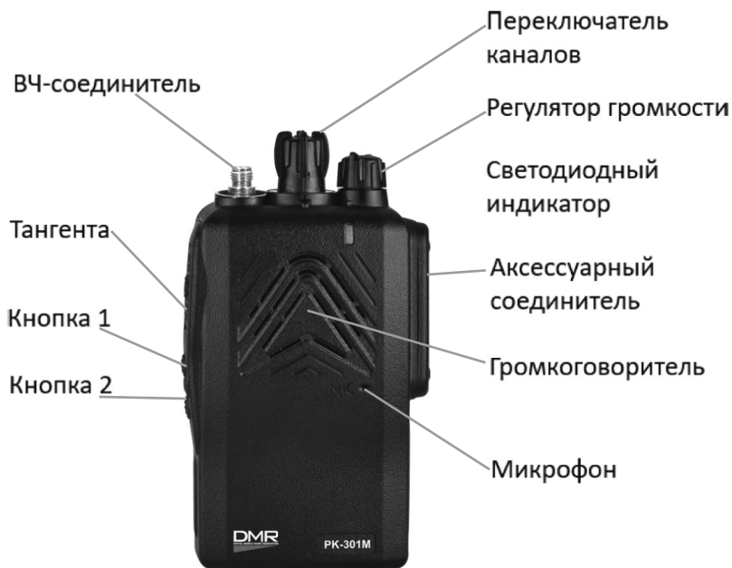
Рис. 1. Расположение органов управления, индикации и соединителей.
