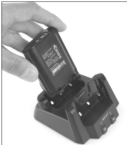
Рис. 8. Установка аккумуляторной батареи в слот 2 зарядной базы.
