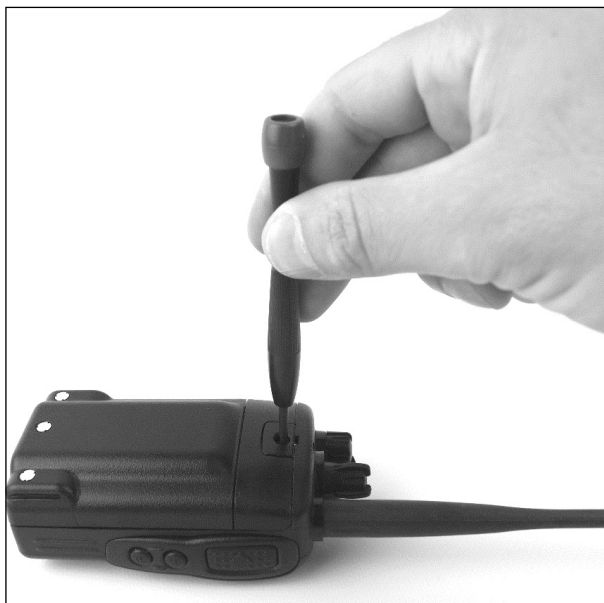
Рис. 5. Снятие заглушки на задней панели радиостанции.
