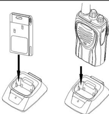
Вставьте блок Ni-MH аккумуляторов или трансивер с блоком аккумуляторов в зарядное устройство.
