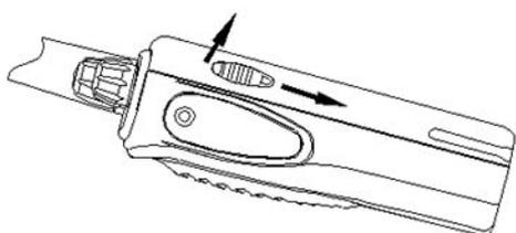
Для удаления блока аккумуляторов сдвиньте его слегка вниз, одновременно, потянув за специальные кнопки на боковых панелях аккумуляторного блока вверх.
