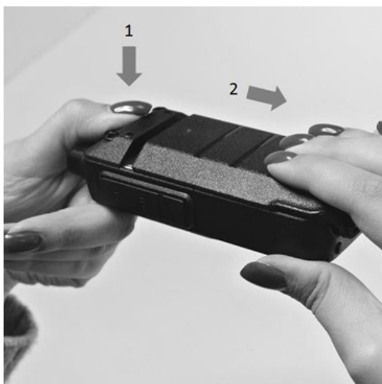
Рис. 3. Снятие аккумуляторной батареи.
