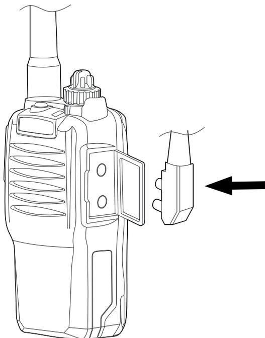
Если вы приобрели проводную гарнитуру и планируете её использовать, подключите её к радиостанции. Для этого отведите в сторону защитную крышку и подключите разъём гарнитуры к аксессуарному соединителю.
