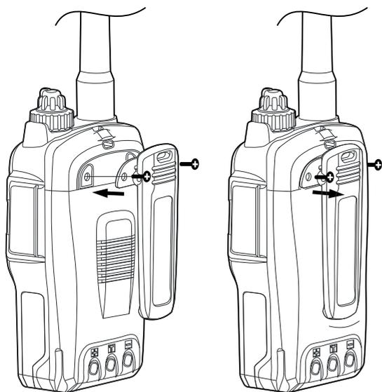
Если вы планируете носить радиостанцию на пояском ремне или крепить к одежде, присоедините к задней панели клипсу. Совместите крепёжные отверстия клипсы с отверстиями на задней панели и закрепите клипсу с помощью двух винтов из комплекта. Используйте крестовую отвёртку №3.
