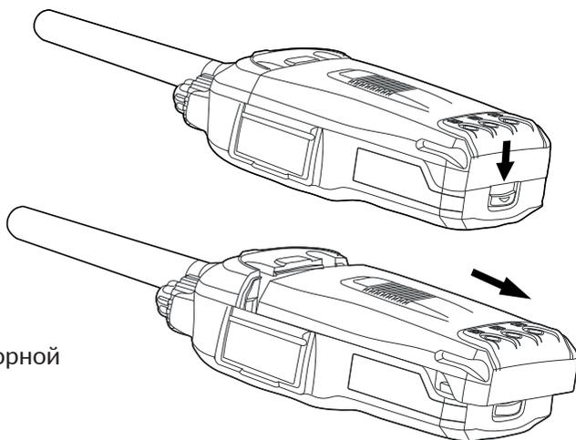
Рис. 3. Снятие аккумуляторной батареи.
