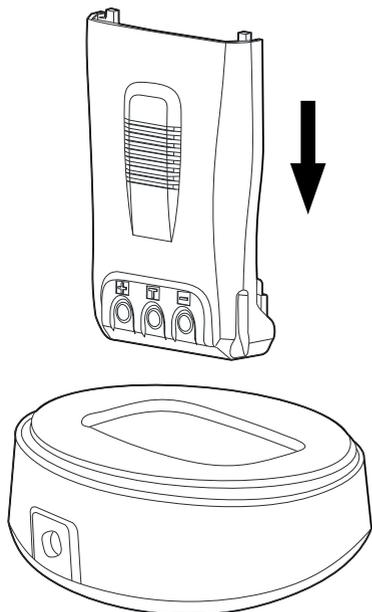
Рис. 7. Установка аккумуляторной батареи на зарядную базу.
