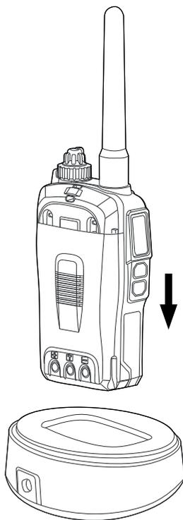
Рис. 6. Установка радиостанции на зарядную базу.
