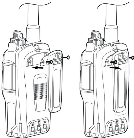
Если вы планируете носить радиостанцию на пояском ремне или крепить к одежде, присоедините к задней панели клипсу. Совместите крепёжные отверстия клипсы с отверстиями на задней панели и закрепите клипсу с помощью двух винтов из комплекта. Используйте крестовую отвёртку №3.
