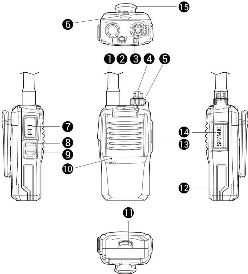
Рис. 1. Расположение органов управления, индикации и соединителей.
