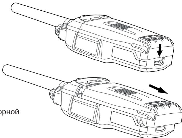
Рис. 3. Снятие аккумуляторной батареи.
