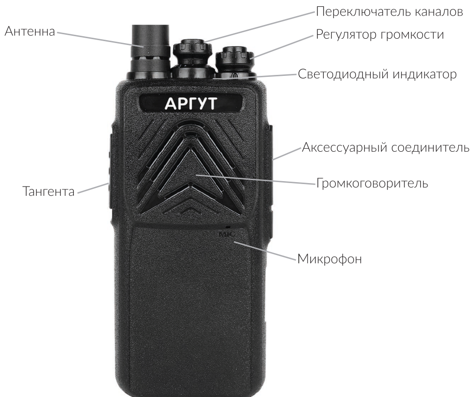
Рис. 1. Расположение органов управления, индикации и соединителей.
