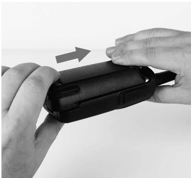
Рис. 2. Установка аккумуляторной батареи.
