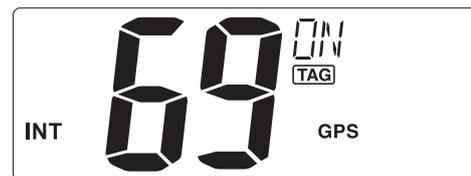
Рис. 6.127 – включение/выключение функции **ATIS SW**
