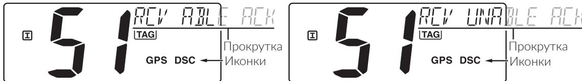
Рис. 6.61 – сообщение **RCV ABLE ACK** или **RCV UNABLE ACK**
