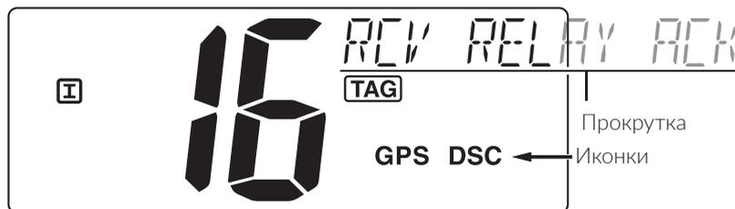
Рис. 6.55 – сообщение **RCV RELAY ACK**
