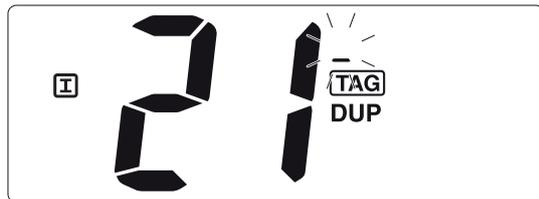
Рис. 6.15 – установка кода **MMSI**
