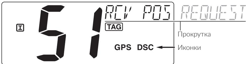
Рис. 6.107 – получение вызова со **статусом судна**
