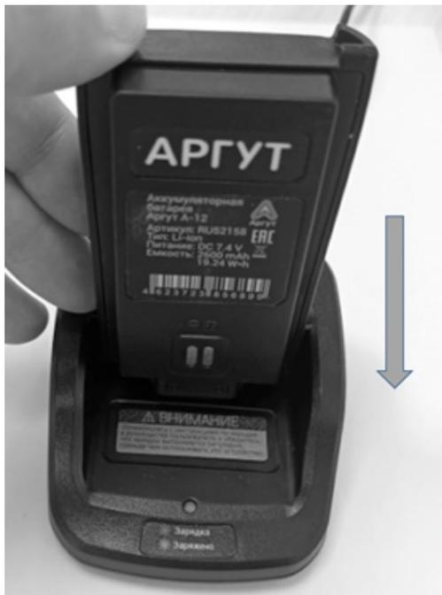
Если вы приобрели сменную аккумуляторную батарею или хотите зарядить комплектную отдельно от радиостанции – совместите направляющие на боковых стенках батареи с направляющими в зарядной базе и установите батарею.
