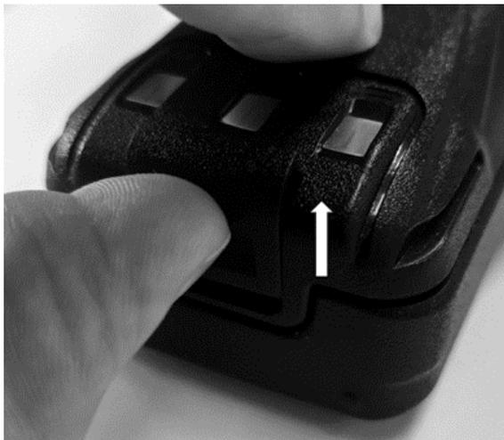
Рис. 5.3. Снятие аккумуляторной батареи.
