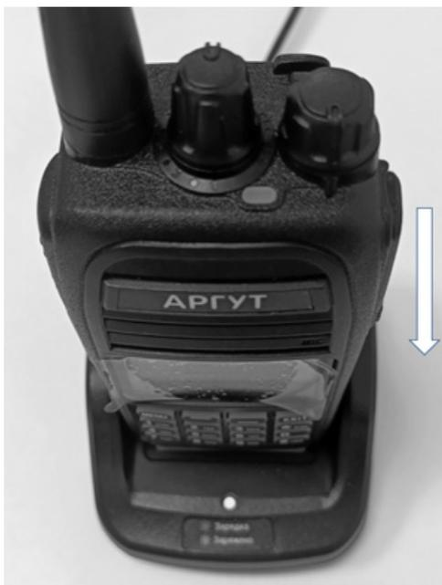
Рис. 5.6. Установка радиостанции на зарядную базу.
