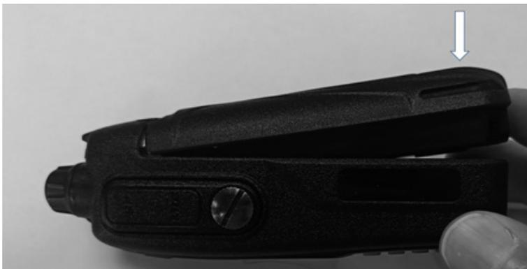
Прижмите аккумуляторную батарею к шасси и отпустите движок механизма фиксации батареи.
