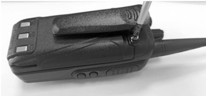
Рис. 5.5. Присоединение зажима для крепления на поясе
