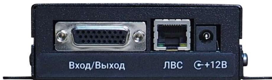
Подключение к техническим средствам осуществляется посредством стека сетевых протоколов ARP, IP, ICMP, UDP, TCP, HTTP, RTP, SIP, аудиокодеков g.711 uLaw, GSM 6.10 FR и сетевого интерфейса ЛВС Ethernet 10/100 Мбит/с. SIP протокол позволяет выполнить подключение к телефонным сетям (цифровые АТС). Выполняется также приём DTMF из эфира для реализации набора номера.
