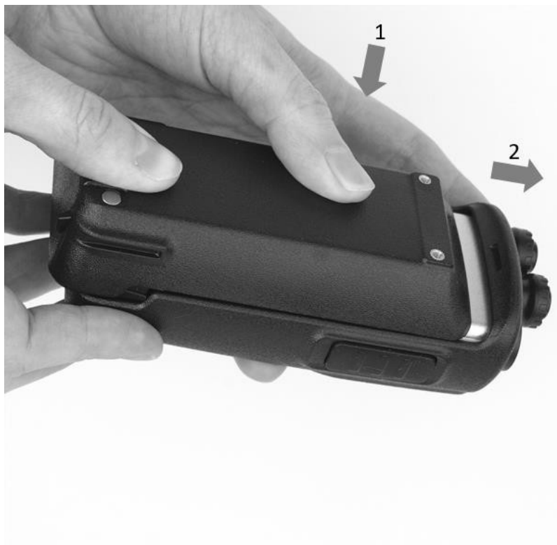
Рис. 2. Установка аккумуляторной батареи.
