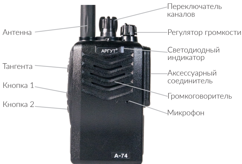
Рис. 1. Расположение органов управления, индикации и соединителей.
