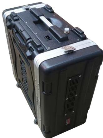
Полевой радиоретранслятор DR-40 – представлен в рэковом кейсе. Данное решение позволяет иметь мобильные быстроразворачиваемый узел радиосвязи на базе цифрового радиоретранслятора Аргут DR-40, который позволяет организовать локально радиосвязь в закрытом канале ориентировочно до 30 км в зависимости от местности, высоты установки антенны и т.д.
