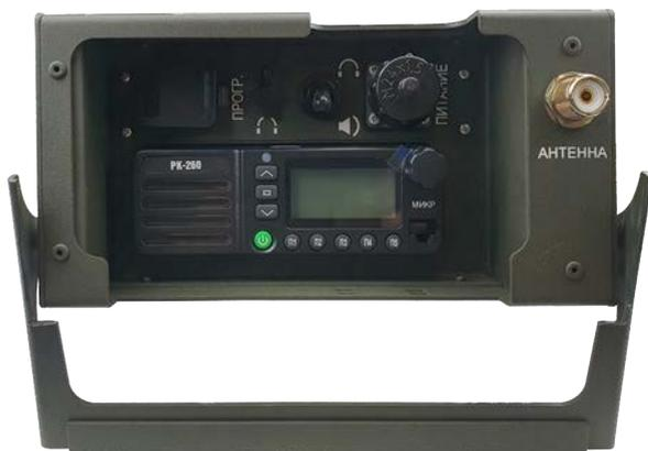
Радиостанция PK-260 разработана в нашей лаборатории позволяет работать как одночастотный (SFR) ретранслятор с возможностью закрытого канала на базе возимой радиостанции. В рэковом корпусе.
