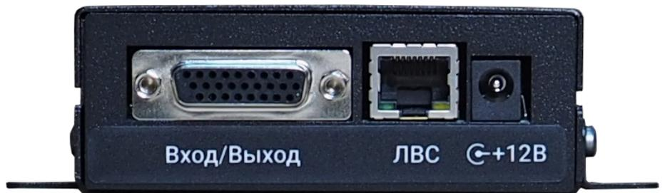
Подключение к техническим средствам осуществляется посредством стека сетевых протоколов ARP, IP, ICMP, UDP, TCP, HTTP, RTP, SIP, аудиокодеков g.711 uLaw, GSM 6.10 FR и сетевого интерфейса ЛВС Ethernet 10/100 Мбит/с. SIP протокол позволяет выполнить подключение к телефонным сетям (цифровые АТС). Выполняется также приём DTMF из эфира для реализации набора номера.
