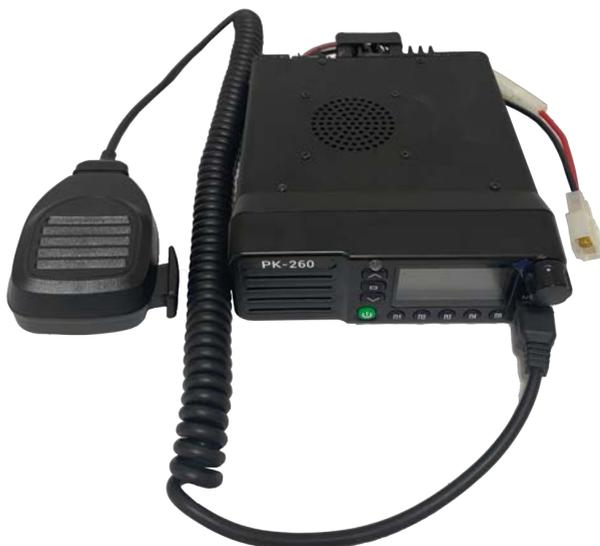
Радиостанция PK-260 разработана в нашей лаборатории позволяет работать как одночастотный (SFR) ретранслятор с возможностью закрытого канала на базе возимой радиостанции.
