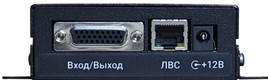
Подключение к техническим средствам осуществляется посредством стека сетевых протоколов ARP, IP, ICMP, UDP, TCP, HTTP, аудиокодеков g.711 uLaw, GSM 6.10 FR и сетевого интерфейса ЛВС Ethernet 10/100 Мбит/с. Внутреннее программное обеспечение «RoIP-XX» имеет Свидетельство о государственной регистрации программы для ЭВМ, выданное Федеральной службой по интеллектуальной собственности.
