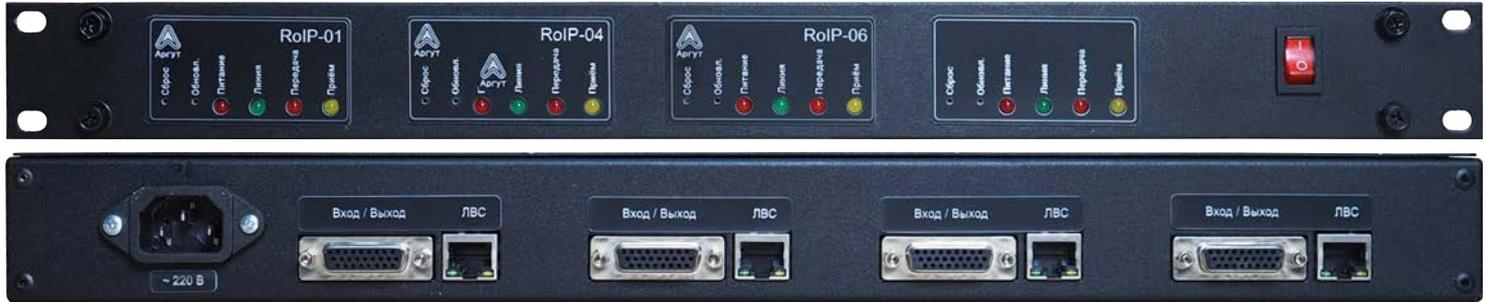
Радиошлюз для удалённого управления радиостанцией по технологии RoIP (Radio Over IP). Радиошлюз RoIP-08 связывает мобильные и базовые радиостанции с RoIP-устройствами Системы радиосвязи Аргут: другой радиошлюз, АПК СУРА, пульт удалённого управления по IP-сети ПУ-02 или ПУ-03. При установке модуля RoIP-06 радиошлюз связывает радиостанцию с SIP-узлом.
