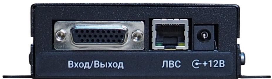
Подключение к техническим средствам осуществляется посредством стека сетевых протоколов ARP, IP, ICMP, UDP, TCP, HTTP, аудиокодеков g.711 uLaw, GSM 6.10 FR и сетевого интерфейса ЛВС Ethernet 10/100 Мбит/с. Внутреннее программное обеспечение «RoIP-XX» имеет Свидетельство о государственной регистрации программы для ЭВМ, выданное Федеральной службой по интеллектуальной собственности.
