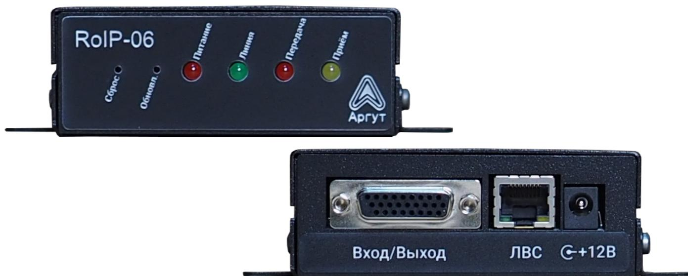
Подключение к техническим средствам осуществляется посредством стека сетевых протоколов ARP, IP, ICMP, UDP, TCP, HTTP, RTP, SIP, аудиокодеков g.711 uLaw, GSM 6.10 FR и сетевого интерфейса ЛВС Ethernet 10/100 Мбит/с. SIP протокол позволяет выполнить подключение к телефонным сетям (цифровые АТС). Выполняется также приём DTMF из эфира для реализации набора номера.
